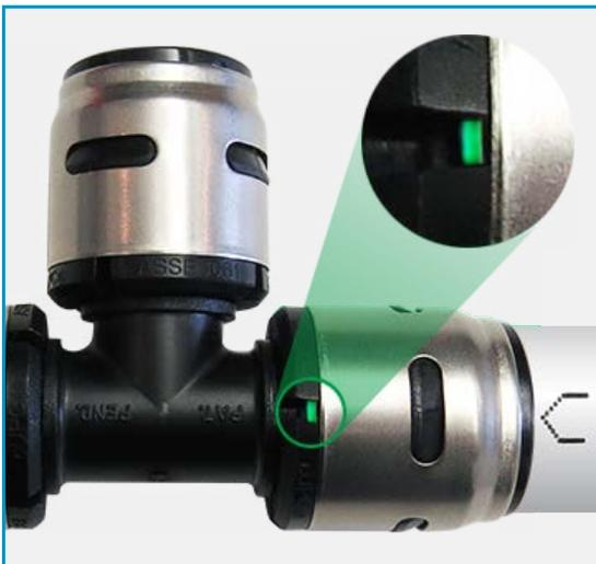
**PASO 3** Asegúrese de que el tubo esté correctamente encastrado en el accesorio y bien conectado, controlando que el anillo indicador verde sea completamente visible en las cuatro ranuras. Esto garantiza una conexión permanente.
