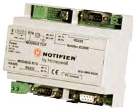
Pasarela de comunicaciones (Gateway) que convierte el protocolo de la central ID3000 en el estándar Modbus Server para comunicarse vía RS232 o RS485 con equipos Modbus RTU o vía Ethernet a través de RJ45 a Modbus TCP. Permite monitorizar una única central con 8 lazos y 99 sensores + 99 módulos y 255 zonas.
