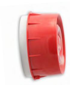
Sirena direccional de color rojo y aislador incorporado. Consumo máx: 11,7mA. Salida de sonido máx. 97dBA +/-3dB @ 1m. Dispone de 32 tonos y 3 niveles de volumen (alto, medio y bajo) seleccionables mediante microinterruptores. Se conecta y alimenta directamente del lazo ocupando una dirección de 0 a 159 de módulo de control.
