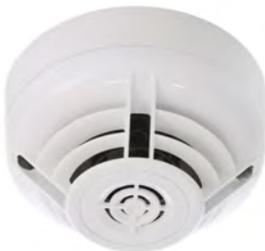
Detector térmico de alta temperatura 78°C analógico con aislador incorporado. Recomendado para la detección de incendios en ambientes donde existen cambios bruscos de temperatura en ciertos periodos de tiempo. Incorpora funciones de test manual y automático y direccionamiento decádico (01-159). Dispone de dos leds para la indicación de alarma y salida para indicador remoto.
