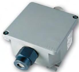
Los detectores de la serie SMART3 NC se han diseñado para ofrecer un producto económico con prestaciones profesionales para áreas no clasificadas. Disponible solo para Metano, LPG, CO, NO<sub>2</sub> y CO<sub>2</sub>. Estos detectores emplean una célula catalítica para detectores de gas inflamable, una célula electroquímica para CO y una sonda infrarroja para la detección de CO<sub>2</sub>.
