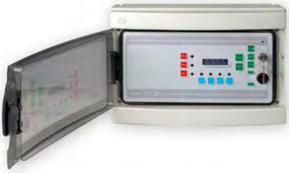
La central microprocesada PL4 representa la mejor tecnología para la detección de materias inflamables, tóxicos y oxígeno en sistemas pequeños. Este panel dispone de 4 entradas analógicas 4-20mA que se pueden actualizar a 8 mediante un módulo de expansión de 4 entradas, fácilmente conectable directamente sobre la unidad. La tarjeta de extensión PL4/ESP ofrece 4 entradas y 16 salidas adicionales de colector abierto.
