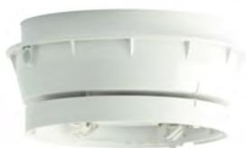
Sirena direccionable integrada en base de detector de color blanco y con aislador. Se conecta y alimenta del lazo ocupando una dirección de módulo de control. Consumo máx: 10,5mA. Salida de sonido máx. 95dBA +/-3dB @ 1m. Dispone de 32 tonos y 3 niveles de volumen (alto, medio y bajo) seleccionable mediante microinterruptores. Permite la instalación de cualquier detector de la serie NFX.
