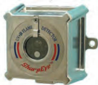
Detector UV/IR compacto con certificado CPD EN54-10 diseñado para la detección de fuegos con llama para aplicaciones industriales en interiores o exteriores. El detector de llamas de tecnología combinada UV/IR incorpora la ventaja de ambas tecnologías y lo hace ideal para la detección, en zonas abiertas, de fuegos con llama a base de hidrocarburos, hidrógeno e hidrógeno y metales o materias orgánicas.
