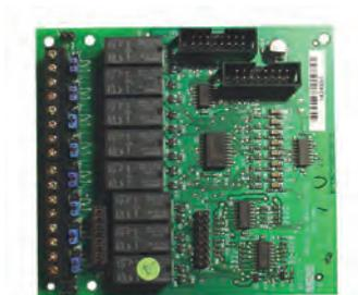
Tarjeta de ampliación con 8 salidas de relés configurables. Se puede instalar un máximo de 2 tarjetas NFS8REL en cada central de la serie NFS.
