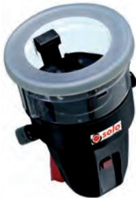
Cabeza generadora de calor transparente que permite ver los leds de disparo para comprobar el funcionamiento de los detectores de temperatura de hasta 90°C/194°F. El calefactor se activa mediante célula infrarroja. Protección de corte de batería a los 120 segundos, rearme a los 5 minutos. Alimentada por baterías recargables que se acoplan entre la cabeza y la pértiga extensible SOLO-100. Autonomía para 50 pruebas de 30 segundos.
