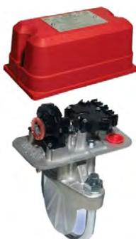
Detector de flujo para tuberías de 3" (76,2mm) con anclaje por abrazadera y disco de color rojo. Dispone de mecanismo de retardo regulable, con ajuste máximo de 30 segundos y doble circuito conmutado con contactos libres de tensión (C/NA/NC).
