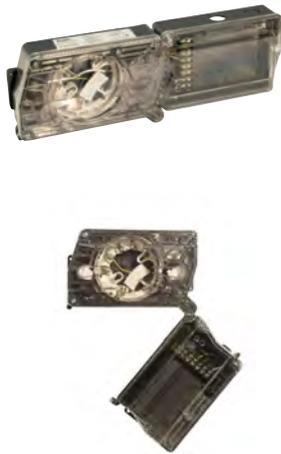
Caja de análisis efecto venturi para la detección de humo en conductos de ventilación y aire acondicionado. Incorpora base B501AP tapa frontal de plástico transparente, salida para indicador remoto y posibilidad de prueba magnética remota.
