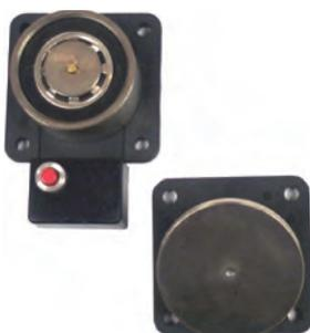
Retenedor para puerta cortafuego de 50Kg/445N. Con placa ferromagnética articulada, sin caja y con pulsador de desbloqueo. El equipo actúa cuando se deja de aplicar la tensión de 24Vcc.
