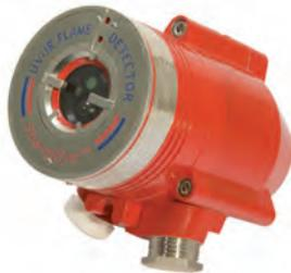
Detector de llama UV (ultravioleta) en carcasa de aluminio con certificado CPD EN54-10 y SIL2. Incorpora un microprocesador para analizar la señal de las llamas, con múltiples niveles de alarma ajustables y prueba manual. Dispone de salida de relé de alarma, avería y relé auxiliar NA.
