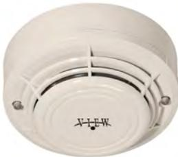
Detector óptico de humo con cámara Láser. Detección analógica con algoritmos AWACS. Ideal para proteger riesgos de alto valor y donde se requiere detección de humo ultrarrápida o en salas hiperventiladas. Incorpora funciones de test manual y automático y direccionamiento decádico (01-99). Dispone de dos leds para la indicación de alarma y salida para indicador remoto.
