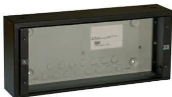
Cabina metálica para ampliación de la cabina CAB-IDA1 del sistema ID3000. Se puede utilizar para alojar el kit de impresora o para instalar baterías auxiliares de 17Ah.
