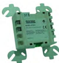
Interface convertidor de corriente para los detectores analógicos de Seguridad Intrínseca IDX-751AE o pulsadores analógicos MCP5A-RP01SG/ISC, máximo 10 dispositivos por interface. El IST200 se debe montar en zona segura fuera de la zona EEX.
