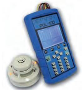
Herramienta de ayuda al instalador en la puesta en marcha y mantenimiento de los sistemas analógicos. Permite diagnosticar el lazo antes de conectarlo a la central, indicando las direcciones de los equipos, posible direcciones duplicadas, además funciona como multímetro permitiendo detectar errores en el cableado.
