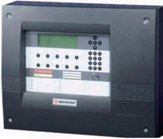
Central microprocesada analógica algorítmica de 2 lazos no ampliable, compatible con todos los dispositivos de la serie 500, 700 y NFX. Incorpora los algoritmos AWACS para realizar la gestión y el control de los sensores láser VIEW de detección ultra rápida. Capacidad para 2 baterías de 12V, 12Ah.
