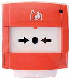
Pulsador de alarma direccionable de 01 a 159 con accionamiento mediante rotura de cristal y aislador de cortocircuitos incorporado. Incluye led de estado, tapa de protección contra rotura accidental y llave para pruebas manuales.
