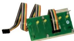
Módulo de leds para la indicación de estado de la fuente de alimentación FA457 si se monta en cabina CAB-FA457.
