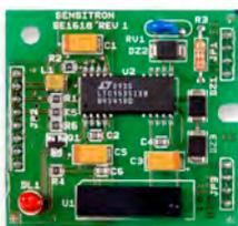
Tarjeta de comunicación serie RS485 adicional para la ampliación de lazos de la central Multiscan.
