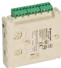
Módulo monitor direccionable con 1 circuito de entrada supervisado con resistencia de final de línea para la monitorización de detectores convencionales a 2 hilos y detectores con seguridad intrínseca. Incorpora circuito aislador de cortocircuito de lazo, led para la indicación del estado del módulo y selector de dirección decádico (01-159).
