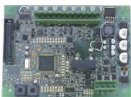
Módulo interfaz de 8 entradas de 4-20mA (8 sensores "SMART 3") para conectar al bus de las centrales MULTISCAN. Requiere caja para montaje G-BOX o similar y alimentación externa de 12 a 24Vcc.
