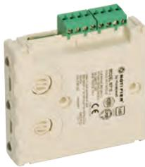
Módulo monitor direccionable con 1 circuito de entrada supervisado para la monitorización de equipos de alarma o de señales técnicas que dispongan de contacto libre de tensión. Incorpora circuito aislador de cortocircuito de lazo, led para la indicación del estado del módulo y selector de dirección decádico (01-159).
