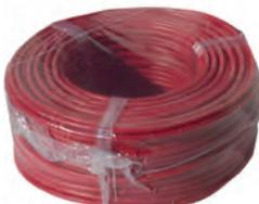
Cable de manguera de par trenzado y apantallado. De color rojo y cobre pulido flexible, clase V de 2x1mm<sup>2</sup>. Pantalla de cinta de aluminio/poliéster y drenaje de cobre estañado de 0,5mm<sup>2</sup>. Recomendado para las conexiones RS485 red Noti•Fire•Net e ID<sup>2</sup>net. Impedancia característica 120 ohmios. No propagador de la llama.
