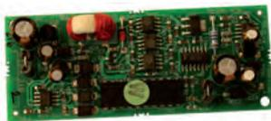
Tarjeta opcional para interfaz de comunicación serie RS485. Permite la conexión de hasta 16 repetidores remotos IDR2A con las centrales analógicas ID50/60.
