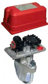
Detector de flujo para tuberías de 4" (101,6mm) con anclaje por abrazadera y disco de color rojo. Dispone de mecanismo de retardo regulable, con ajuste máximo de 30 segundos y doble circuito conmutado con contactos libres de tensión (C/NA/NC).
