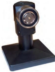
Retenedor para puerta cortafuego de 50Kg/445N. Con placa ferromagnética, pulsador de desbloqueo y brazo extensible de 300 a 330mm, para instalación en suelo o pared. El equipo actúa cuando se deja de aplicar la tensión de 24Vcc.
