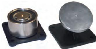
Retenedor para puerta cortafuego de 50Kg/445N. Con placa ferromagnética articulada, sin caja ni pulsador de desbloqueo. El equipo actúa cuando se deja de aplicar la tensión de 24Vcc.
