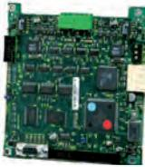
Tarjeta interfaz que permite conectar las centrales ID3000 con la red ID<sup>2</sup>net mediante cable de par trenzado. Se conecta a la CPU del sistema ID3000 e incorpora circuito de aislamiento eléctrico entre nodos e interfaz RS232 para autodiagnóstico.
