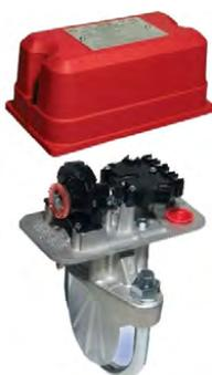
Detector de flujo para tuberías de 2,5" (63,5mm) con anclaje por abrazadera y disco de color rojo. Dispone de mecanismo de retardo regulable, con ajuste máximo de 30 segundos y doble circuito conmutado con contactos libres de tensión (C/NA/NC).
