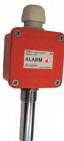
Sonda térmica autorrearmable con rango de activación entre 54°C y 65°C montada en caja estanca con grado de protección IP65. Apto para interiores y exteriores. Compatible con las centrales analógicas de NOTIFIER, mediante un módulo interfaz M710CZR, y la mayoría de centrales convencionales del mercado.
