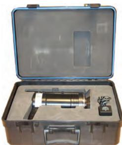
Maletín de pruebas que incluye un simulador de llama en carcasa antideflagrante y un amplificador óptico para comprobar los detectores de llama SPECTREX UV y UV+IR.
