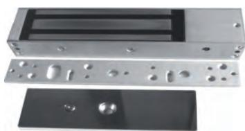
Electroimán para puertas de emergencia y montaje en superficie de 500 Kg/4900 N. Cuerpo de aluminio, placa ferromagnética de acero galvanizado, led y relé indicadores de estado.
