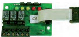
Tarjeta enchufable de 3 relés para detectores SMART 3 GC. Relés a 12 ó 24Vcc.
