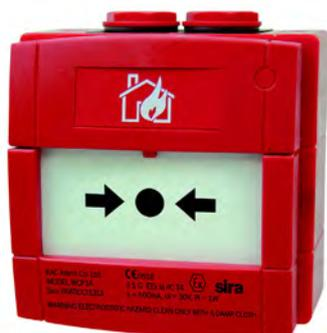
Pulsador de alarma por rotura de cristal de color rojo con resistencia de alarma de 470Ω para sistemas convencionales. Diseñado para su uso en exteriores y montaje en superficie. Homologado para su uso tanto en atmósferas con gas en Zonas 0, 1 y 2 como en ambientes con polvo combustible, en Zonas 20, 21 y 22.
