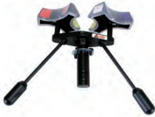
Elemento con tres semicircunferencias intercambiables para detectores con diámetro entre 55 y 105mm. La cabeza es basculante para poder acceder al detector desde cualquier ángulo respecto a la vertical o bien se puede mantener fija para su uso en posición recta.
