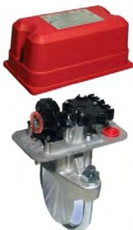
Detector de flujo para tuberías de 8" (203,2mm) con anclaje por abrazadera y disco de color rojo. Dispone de mecanismo de retardo regulable, con ajuste máximo de 30 segundos y doble circuito conmutado con contactos libres de tensión (C/NA/NC).
