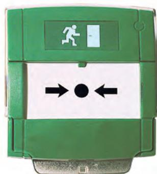
Pulsador de evacuación por rotura de cristal con contacto NA o NC, de color verde para salidas de emergencia. Diseñado para uso exclusivo en interiores y montaje en superficie o empotrado mediante caja estándar.
