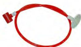
Punto de muestreo capilar compuesto de tubo de nylon flexible de 1 metro de longitud, 10mm de diámetro exterior y 8mm de diámetro interior, soporte para falso techo y empalme tipo T para conectar a la red de tuberías de aspiración. Ideal para montajes en falso techos.
