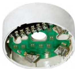
Base estándar con calefactor, compatible con los detectores analógicos de la serie 500, 700 y NFX (aislador no operativo). Aumenta unos grados la temperatura del detector para evitar que se produzca condensación en la cámara de detección.
