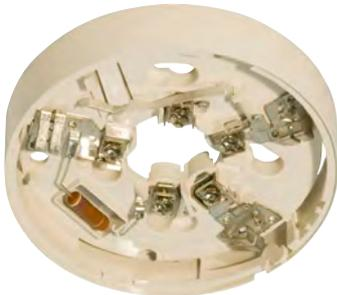
Base estándar de superficie con resistencia limitadora de corriente de 470 Ohmios para detectores convencionales de las series 400, 600 y 800. Dispone de automatismo de bloqueo y terminales de conexión para cable de hasta 2,5mm<sup>2</sup>. Recomendada para la conexión de los detectores de la serie 400, 600 y 800 al módulo M710CZR.
