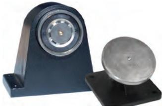
Retenedor de suelo para puerta cortafuego de 50Kg/445N. Con placa ferromagnética, pulsador de desbloqueo y soporte para montaje en suelo. El equipo actúa cuando se deja de aplicar la tensión de 24Vcc.
