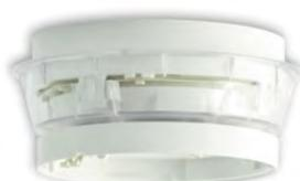
Sirena con flash direccionable integrada en base de detector de color blanco y con aislador. Se conecta y alimenta del lazo ocupando una dirección de módulo de control. Consumo máx: 14mA. Salida de sonido máx. 95dBA +/-3dB @ 1m. Frecuencia del flash estroboscópico: 1Hz. Dispone de 32 tonos y 3 niveles de volumen (alto, medio y bajo) seleccionable mediante microinterruptores. Permite la instalación de cualquier detector de la serie NFX.
