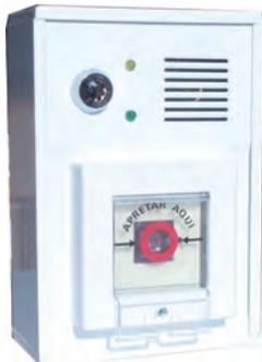
Unidad de control para accionamiento de las puertas de emergencia. Dispone de leds indicadores para los modelos con relé y sirena piezoeléctrica de aviso de alarma. El desbloqueo se puede realizar con una llave o rompiendo el cristal del pulsador. Conexión mediante bornes que admiten el accionamiento a través de un dispositivo exterior, como por ejemplo un módulo de control de un sistema analógico.
