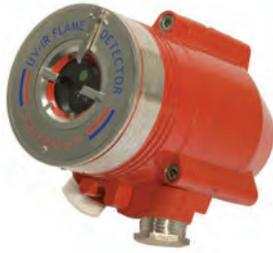
Detector de llama UV (ultravioleta) e IR (Infrarrojo) en carcasa de aluminio con certificado CPD EN54-10 y SIL2. Detecta fuegos de combustibles a base de hidrocarburos, hidróxido e hidrógeno y metales o materia inorgánica. Incorpora microprocesador para analizar la señal de las llamas, múltiples niveles de alarma ajustables. Montado en carcasa de aluminio antideflagrante. Dispone de salida de relé de alarma, avería y relé auxiliar NA.
