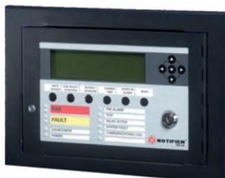
Panel repetidor remoto con pantalla gráfica de cristal líquido LCD 240 X 64 píxeles (6 líneas de 40 caracteres alfanuméricos), compatible con las centrales analógicas de la serie ID3000. Incorpora avisador, teclado de membrana protegido con llave de acceso y leds para visualizar el estado del sistema.
