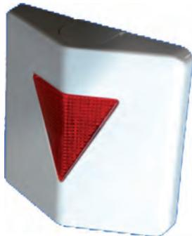
Indicador remoto de acción compatible con todos los detectores de incendio de Notifier. Recomendado para visualizar el estado de alarma de los detectores instalados en recintos cerrados u ocultos. Dispone de entrada pretaladrada para tubo en la parte superior que facilita su montaje.
