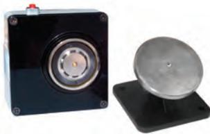
Retenedor para puerta cortafuego de 100Kg/1100N. Con placa ferromagnética, caja y pulsador de desbloqueo. El equipo actúa cuando se deja de aplicar la tensión de 24Vcc.
