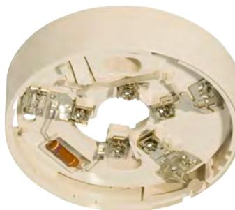
Base estándar alta con resistencia limitadora de corriente de 470 Ohmios para instalaciones con tubo visto para sensores de las series 400, 600 y 800. Con el adaptador BA-1AP-IV permite la entrada de tubos de 18 y 20mm de diámetro exterior. Dispone de automatismo de bloqueo y terminales de conexión para cable de hasta 2,5mm<sup>2</sup>.
