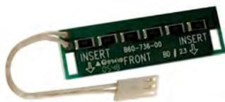
Circuito calefactor para acoplar a la barrera de la serie 6500R. Aumenta unos grados la temperatura del detector para evitar que se produzca condensación. Se monta en el interior de la barrera.
