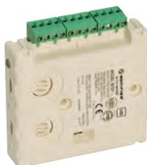
Módulo de control direccionable para la activación de sistemas de señalización, puertas, compuertas cortafuego, solenoides, etc. Dispone de 1 circuito de salida configurable, mediante microinterruptor, como salida supervisada con RFL o en forma relé con contactos libres de tensión. Incorpora circuito aislador de cortocircuito de lazo, led para la indicación del estado del módulo y selector de dirección decádico (01-159).
