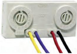
Mini módulo monitor direccionable con protocolo OPAL. Dispone de 1 circuito de entrada supervisada para la monitorización de equipos de iniciación de alarma o de señales técnicas que dispongan de contacto libre de tensión. Se conecta directamente al lazo de comunicaciones analógico. Incorpora direccionamiento decádico (01-159).
