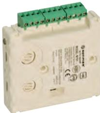
Módulo monitor direccionable con 2 circuitos de entrada supervisados para la monitorización de equipos de alarma o de señales técnicas que dispongan de contacto libre de tensión. Incorpora circuito aislador de cortocircuito de lazo, leds para la indicación del estado del módulo y selector de dirección decádico (01-159).
