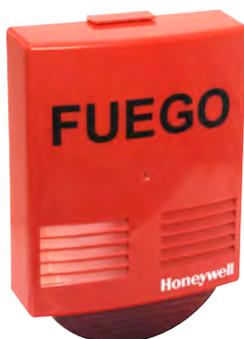
Sirena exterior bitonal óptico-acústica de color rojo con potencia de 95 dB a 1 metro. Grado de protección IP54. Opción de 3 ciclos de 1 minuto o activación continua.
