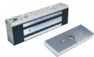
Electroimán para puertas de emergencia y montaje en superficie de 500Kg/4900N. Cuerpo de acero inoxidable, placa ferromagnética de acero galvanizado, led y relé indicadores de estado.
