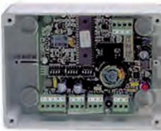
Interface direccionable con 4 circuitos de entrada para la supervisión de señales analógicas de 4-20 mA procedentes de detectores de gases inflamables o tóxicos. Incorpora direccionamiento decádico (1-99) y se conecta directamente al lazo de comunicaciones analógico, ocupando 12 direcciones consecutivas de detectores. Incluye caja de plástico para montaje en superficie.
