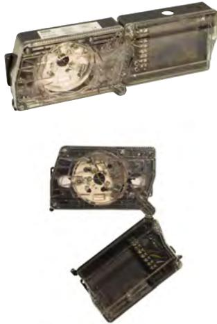
Caja de análisis efecto venturi para la detección de humo en conductos de ventilación y aire acondicionado. Dispone de tapa frontal de plástico transparente, salida para indicador remoto y posibilidad de prueba magnética remota. No incorpora base.
