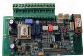
Comunicador telefónico a central receptora de alarmas utilizando el formato de comunicación por punto CONTACT ID. Transmisión de eventos por zona o punto configurable en el propio equipo. Compatible con la red telefónica conmutada RTC. Requiere alimentación de 24Vcc e interfaz de salida RS232.
