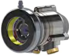
El escudo de aire permite la conexión de un tubo de aire comprimido que proporciona una cortina de aire para evitar la acumulación de suciedad en la ventana del detector y reducir la frecuencia de mantenimiento en entornos contaminados o sucios. Compatible con todos los detectores de la serie S40/40 menos el S40/40M.
