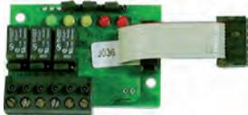
Tarjeta enchufable de 3 relés para detectores SMART 3 GD. Incluye cable plano de 50cm. SMART 3 IrDA. Relés a 12 ó 24Vcc.
