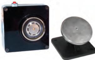
Retenedor para puerta cortafuego de 50Kg/445N. Con placa ferromagnética, caja y pulsador de desbloqueo. El equipo actúa cuando se deja de aplicar la tensión de 24Vcc.
