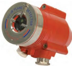
Detector de llama UV (ultravioleta) e IR (infrarrojo), con las mismas prestaciones que el S40/40L, pero con la excepción de que el sensor IR funciona a una longitud de onda de 4,5µm y solo es adecuado para los fuegos de hidrocarburos.
