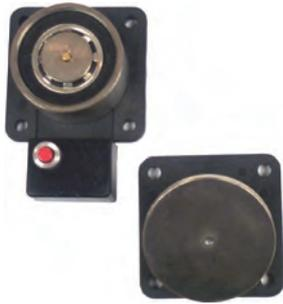
Retenedor para puerta cortafuego de 100Kg/1110N. Con placa ferromagnética articulada, sin caja y con pulsador de desbloqueo. El equipo actúa cuando se deja de aplicar la tensión de 24Vcc.
