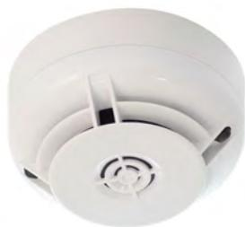
Detector óptico de humo con aislador incorporado. Detección analógica con algoritmos de procesamiento de la señales captadas por el detector. Ideal para fuegos de evolución lenta, con partículas de humo visibles. Incorpora funciones de test manual y automático y direccionamiento manual decádico (01-159). Dispone de dos leds para la indicación de alarma y salida para indicador remoto.
