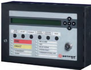
Panel repetidor remoto con pantalla alfanumérica de cristal líquido LCD de 2 líneas de 40 caracteres alfanuméricos. Incorpora avisador, teclado de membrana protegido con llave de acceso a las teclas de control y función y leds para la visualización del estado del sistema. Es compatible con las centrales analógicas ID50/60 y se conecta al interfaz de comunicaciones opcional SIB5485.
