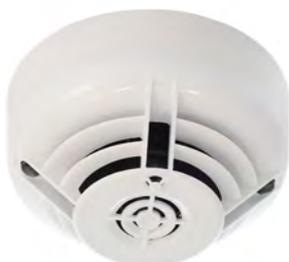
Detector de tecnología combinada, con aislador incorporado, que incorpora tres elementos de detección independientes para actuar como un único equipo: detección IR para medir los niveles de radiación en el ambiente y los parámetros de las llamas, la detección óptica y la térmica. Dispone de dos leds rojos que ofrecen indicación visual del estado del detector desde cualquier punto y salida para indicador remoto. Direccionamiento decádico 01 a 159.
