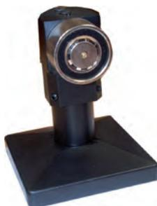
Retenedor para puerta cortafuego de 50Kg/445N. Con placa ferromagnética, pulsador de desbloqueo y brazo extensible de 150 a 180mm, para instalación en suelo o pared. El equipo actúa cuando se deja de aplicar la tensión de 24Vcc.
