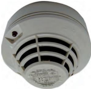
Detector térmico termovelocimétrico convencional intrínsecamente seguro "EEx ia". Recomendado para la detección de incendios en zonas con peligro de explosión (zonas 0, 1 y 2), donde la temperatura es baja y estable. Integra la función de temperatura fija 59°C. Incorpora funciones de test manual, doble led para la indicación de alarma y salida para indicador remoto.
