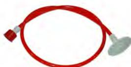
Punto de muestreo capilar compuesto de tubo de nylon flexible de 1 metro de longitud, 10mm de diámetro exterior y 8mm de diámetro interior y soporte para falso techo. Se conecta al final de la red de tuberías de aspiración. Ideal para montajes en falso techos.
