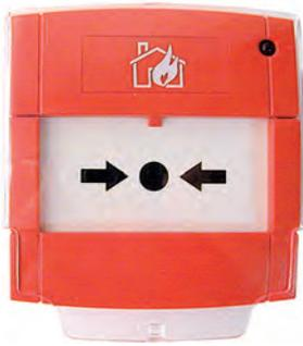
Pulsador de alarma direccionable de 01 a 159, rearmable y con aislador de cortocircuitos incorporado. Incluye led de estado, tapa de protección contra rotura accidental y llave para pruebas manuales.
