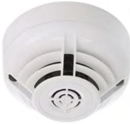
Detector térmico termovelocimétrico analógico con aislador incorporado. Recomendado para la detección de incendios en ambientes donde la temperatura es baja y estable. Integra la función de temperatura fija 58°C y termovelocimétrica, con funciones de test manual y automático y direccionamiento decádico (01-159). Dispone de dos leds para la indicación de alarma y salida para indicador remoto.
