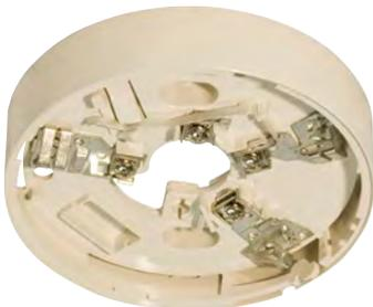
Base estándar alta para instalaciones con tubo visto para sensores de la serie 400, 600 y 800. Con el adaptador BA-1AP-IV permite la entrada de tubos de 18 y 20mm de diámetro exterior. Dispone de automatismo de bloqueo y terminales de conexión para cable de hasta 2,5mm<sup>2</sup>.
