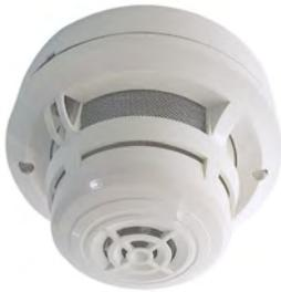
Incorpora cuatro elementos de detección independientes para actuar como un único equipo: detección de CO (con célula electroquímica) para supervisión de los productos de CO procedentes de un fuego, detección IR para medir los niveles de radiación en el ambiente y los parámetros de las llamas, la detección óptica y la térmica. Dispone de dos leds para la indicación de alarma y salida para indicador remoto. Direccionamiento decádico 01 a 159.
