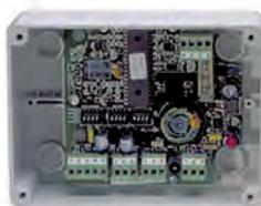
Interface direccionable con 4 circuitos de entrada para la supervisión de señales analógicas de 4-20 mA procedentes de detectores de gases inflamables o tóxicos. Incorpora direccionamiento decádico (1-99) y se conecta directamente al lazo de comunicaciones analógico, ocupando 12 direcciones consecutivas de detectores. Incluye caja de plástico para montaje en superficie.
