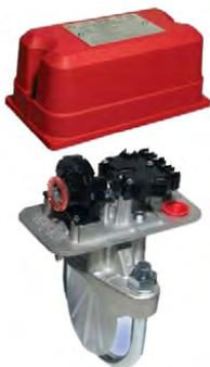
Detector de flujo para tuberías de 6" (152,4mm) con anclaje por abrazadera y disco de color rojo. Dispone de mecanismo de retardo regulable, con ajuste máximo de 30 segundos y doble circuito conmutado con contactos libres de tensión (C/NA/NC).
