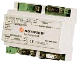
Pasarela de comunicaciones (Gateway) que convierte el protocolo de la central ID50/60 en el estándar Modbus Server para comunicarse vía RS232 o RS485 con equipos Modbus RTU o vía Ethernet a través de RJ45 a Modbus TCP. Permite monitorizar una única central con 1 lazos y 99 sensores + 99 módulos y 16 zonas.
