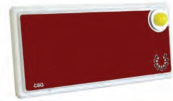
Panel óptico/acústico de señalización diseñado para indicar el estado del sistema de extinción automática de incendios. La señalización óptica de alarma está garantizada por un eficiente luz brillante flash LED. Dotado de pictograma retroiluminado con la palabra "ALARMA DE FUEGO". Con grado de protección IP54 para permitir su uso en interiores y al aire libre, húmedos y / o polvorientos.
