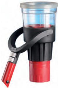
Cabeza difusora transparente que permite ver los leds de comprobación del funcionamiento de los detectores de humo. Se acciona a través de una ligera presión contra el techo. Dispone de alojamiento ajustable para el envase de gas de pruebas SOLO-A3. La cabeza es basculante para poder acceder al detector desde cualquier ángulo respecto a la vertical.
