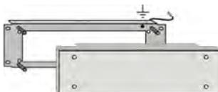
Tapa ciega de 3U para el montaje en rack de 19".
