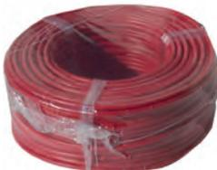
Cable de manguera de par trenzado y apantallado. De color rojo y cobre pulido flexible, clase V de 1,5mm<sup>2</sup>. Pantalla con cinta de aluminio/poliéster y drenaje de cobre estañado de 0,5mm<sup>2</sup>. Recomendado para la instalación de los lazos analógicos de NOTIFIER. Resistente al fuego, libre de halógenos, baja emisión de humo y baja corrosividad.
