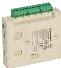
Módulo monitor direccionable con 1 circuito de entrada supervisado con condensador de final de línea para la monitorización de detectores convencionales a 2 hilos. Incorpora circuito aislador de cortocircuito de lazo, led para la indicación del estado del módulo y selector de dirección decádico (01-159).
