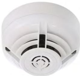
Detector térmico de temperatura fija 58°C analógico con aislador incorporado. Recomendado para la detección de incendios en ambientes donde existen cambios bruscos de temperatura en ciertos periodos de tiempo. Incorpora funciones de test manual y automático y direccionamiento decádico (01-159). Dispone de dos leds para la indicación de alarma y salida para indicador remoto.
