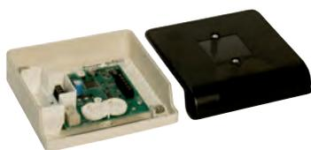
Módulo de control direccionable para poder realizar las maniobras de activación/desactivación a través del lazo de comunicaciones en sistemas que trabajen con tensiones de 240Vca, mediante un contacto libre de tensión NA/NC independiente. Incorpora circuito aislador de cortocircuito de lazo, led para la indicación del estado del módulo y selector de dirección decádico (01-159).
