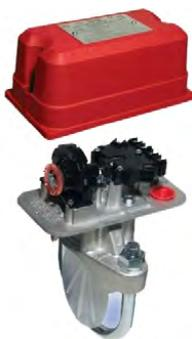
Detector de flujo para tuberías de 2" (50,8mm) con anclaje por abrazadera y disco de color rojo. Dispone de mecanismo de retardo regulable, con ajuste máximo de 30 segundos y doble circuito conmutado con contactos libres de tensión (C/NA/NC).
