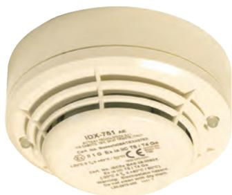
Detector óptico de humo analógico intrínsecamente Seguro "EEX ia". Detección analógica con algoritmos de procesamiento de las señales captadas por el detector. Ideal para instalaciones en zonas clasificadas (zonas 0, 1 y 2). Incorpora funciones de test manual y automático y direccionamiento manual decádico (01-99). Incorpora 2 leds para la indicación de alarma y salida para indicador remoto.
