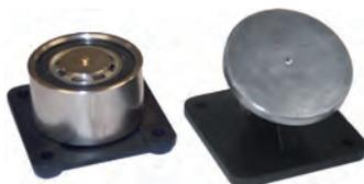
Retenedor para puerta cortafuego de 100Kg/1110N. Con placa ferromagnética articulada, sin caja ni pulsador de desbloqueo. El equipo actúa cuando se deja de aplicar la tensión de 24Vcc.
