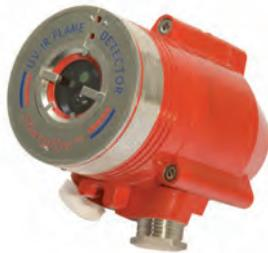
Detector de llama IR (infrarrojo) en carcasa de aluminio con certificado CPD EN54-10 y SIL2. Incorpora un microprocesador para analizar la señal de las llamas, con múltiples niveles de alarma ajustables y prueba manual. Detecta fuegos de combustibles de hidrocarburo y fuegos de gas mediante un sistema avanzado de análisis de llama. Dispone de salida de relé de alarma, avería y relé auxiliar NA.
