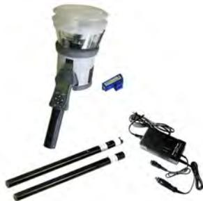
Cabeza de comprobación de detectores electrónica con dosificador de humo y calefactor, controlado por microprocesador. Permite seleccionar el orden de prueba y realizar el barrido con aire de la cámara de los detectores. Leds indicadores de funcionamiento de modo de prueba (Humo, Calor o Limpieza) fallo y batería baja. Dispone de cartucho de pruebas con humo concentrado para generar la correcta dosificación para el test. Incluye batería de reserva y cargador para alimentación o coche.
