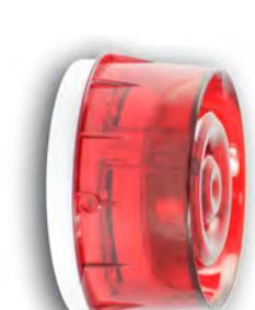
Sirena direccional con flash de color rojo y aislador incorporado. Consumo máx: 14,7mA. Salida de sonido máx. 97dBA +/-3dB @ 1m. Frecuencia del flash estroboscópico: 1Hz. Dispone de 32 tonos y 3 niveles de volumen (alto, medio y bajo) seleccionables mediante microinterruptores. Se conecta alimenta directamente del lazo ocupando una dirección de 0 a 159 de módulo de control.
