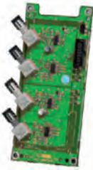
Tarjeta interfaz que permite conectar las centrales ID3000 con la red ID<sup>2</sup>net mediante cable de fibra óptica, recomendado para distancias superiores a 500 metros o para ambientes industriales. Se conecta a la tarjeta ISO-IDRED/W. Incorpora circuito de regeneración y amplificación de señal. Distancia máxima, dependiendo del tipo de fibra, entre nodos de 3000 metros.
