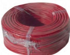
Cable de manguera de par trenzado y apantallado. De color rojo y cobre pulido flexible, clase V de 1,5mm<sup>2</sup>. Pantalla con cinta de aluminio/poliéster y drenaje de cobre estañado de 0,5mm<sup>2</sup>. Recomendado para la instalación de los lazos analógicos de NOTIFIER. No propagador de la llama, libre de halógenos, baja emisión de humo y baja corrosividad.
